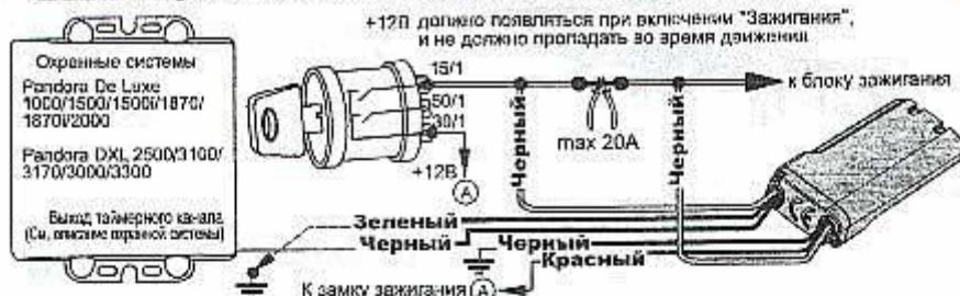
В режиме программирования "Зеленый" провод соединить с выходом таймерного канала, после успешного программирования "Зеленый" провод отсоединить и заизолировать.
